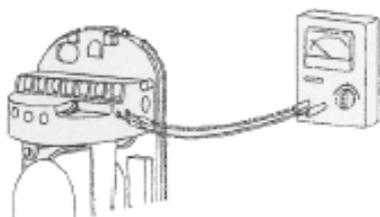
Наилучшая настройка положения оптической оси может быть достигнута при правильном подключении напряжения вольтметра.
