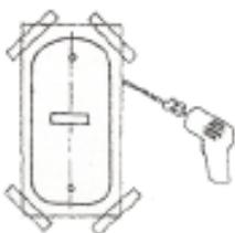
2. Приложите к стене закрепляемую заднюю крышку. Отметьте места под отверстия и сделайте эти отверстия.
