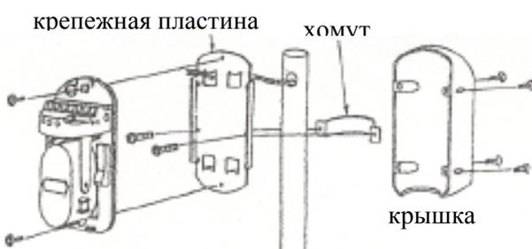
2. Протяните провода через конструкцию датчика и прикрепите датчик к крепежной пластине
