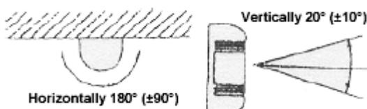
Т.к. угол настройки положения может составлять  $180^\circ (\pm 90^\circ)$  в горизонтальной плоскости и  $20^\circ (\pm 10^\circ)$  в вертикальной плоскости, передатчик и приемник могут иметь различное взаимное расположение.
