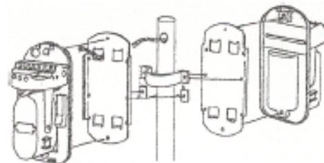
3. Закрепите устройство на столбе. Подсоедините провода к соответствующим клеммам
