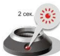
При подключении нового ключа светодиод загорается на 2 секунды.
