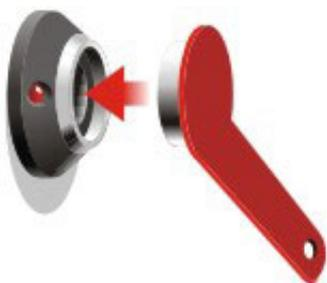
Для программирования электронных ключей ТМ их следует просто подключить их к входу считывателя.
