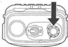
Включите трансивер поворотом ручки регулировки громкости по часовой стрелке.
