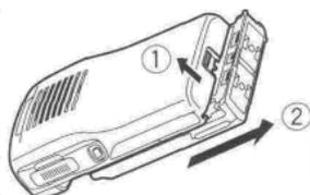
Для извлечения аккумулятора потяните назад до срабатывания защелки и двигайте аккумулятор вдоль трансивера.
