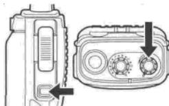
Отрегулируйте звук нажатием и удержанием кнопки Монитор, затем поворотом ручки громкости.
