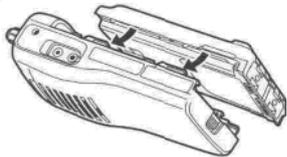
Совместите четыре углубления аккумулятора с соответствующими направляющими на задней части трансивера.
