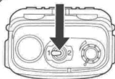
Установите переключатель каналов для выбора желаемого канала.
