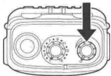
Выключите трансивер поворотом ручки регулировки громкости по часовой стрелке.
