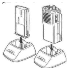
Двигайте NiCd аккумулятор, или трансивер с NiCd аккумулятором в зарядное устройство.
