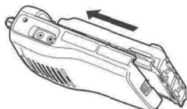
Двигайте аккумулятор по задней части трансивера до срабатывания защелки.
